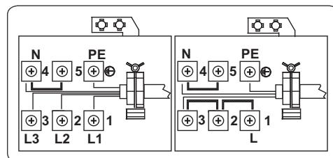
Необходимо использовать кабель питания  $3 \times 2,5 \text{ mm}^2$ , НО5V V-F. Провод заземления должен быть подключен к винту с символом .
