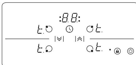
При снижении температуры символ „t“ на дисплее нагревателя исчезнет, а блок управления варочной панелью вернется в режим S. Это означает, что можно снова включить прибор, нажав кнопку .
