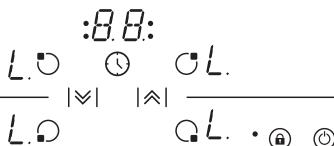
Если таймер напоминания продолжает работать, этот процесс продлится до достижения значения „00“, после чего раздастся звуковой сигнал. После подтверждения завершения времени работы таймера прибор будет полностью заблокирован. На заблокированном приборе не удастся нажать ни одну из кнопок.
