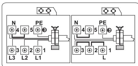
3 x 2,5 mm<sup>2</sup>, H05V V-F – треба да се користи ваков тип на кабел. Заземувањето треба да се поврзе со гвинт со симбол.
