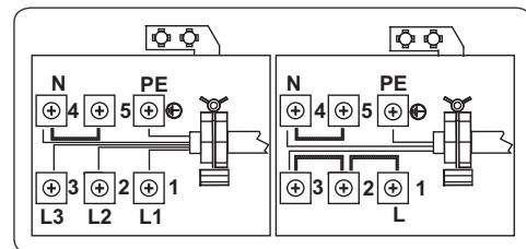
Трябва да се използва захранващ кабел тип 3 x 2,5 mm<sup>2</sup>, HO5V V-F. Заземяващият проводник трябва да се свърже към винт със символа .
