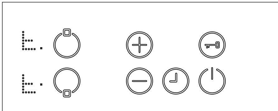
Nakon opadanja temperature, znak "t" nestaje, i ploča prelazi u S-režim. Ovo znači da je moguća ponovna upotreba uređaja pritiskom na taster .
