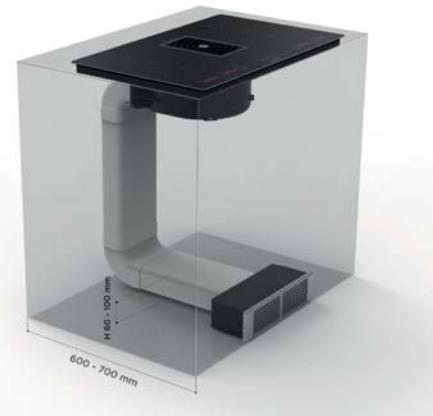
Montaža u režim filtracije sa prednjim odvodom za vazduh
