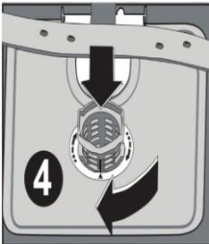
2. Dobro ga isperite pod jakim mlazom vode. Vratite metalni/plastični filter. Ubacite grubi filter u mikro filter.
