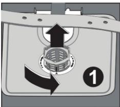
Da bi uklonili i očistili filter, okrenite ga u smeru suprotnom od skazaljki na satui izvucite ga. 1
